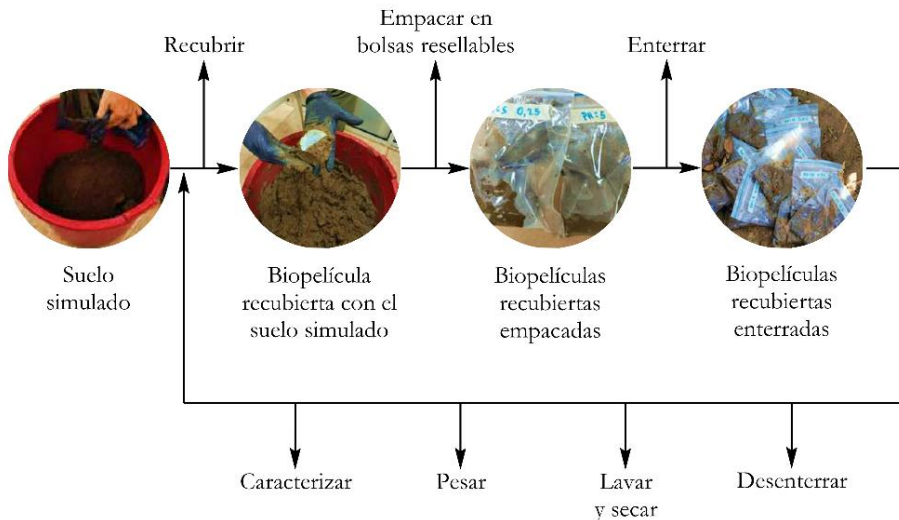
Figura 3.5. Representación del proceso de biodegradabilidad en suelo simulado.
