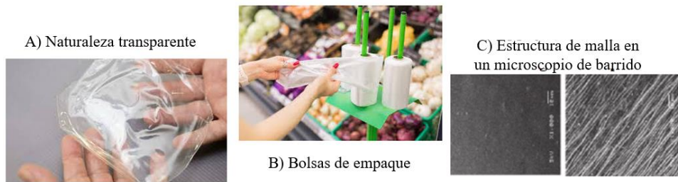
Figura 5.2. A) Forma estructural de una película a base de almidón; B) bolsa de transporte; C) imagen estructural de malla revelada mediante un microscopio de barrido (adaptado de Tumwesigye et al., 2016).
